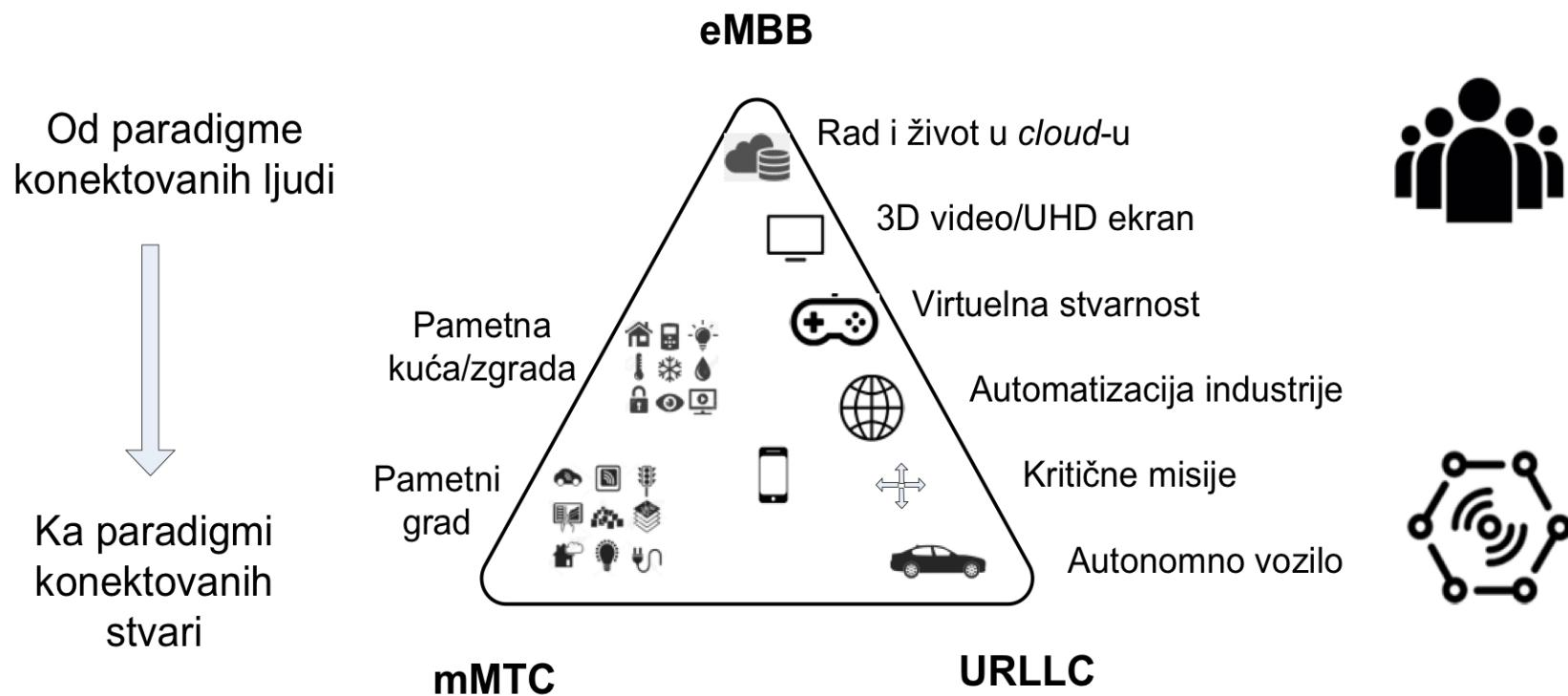
(*eMBB-napredni mobilni širokopojasni sistemi; mMTC-sistemi za masovnu komunikaciju izmedju uređaja (mašina); URLLC-sistemi sa ultra malim kašnjenjem*)
